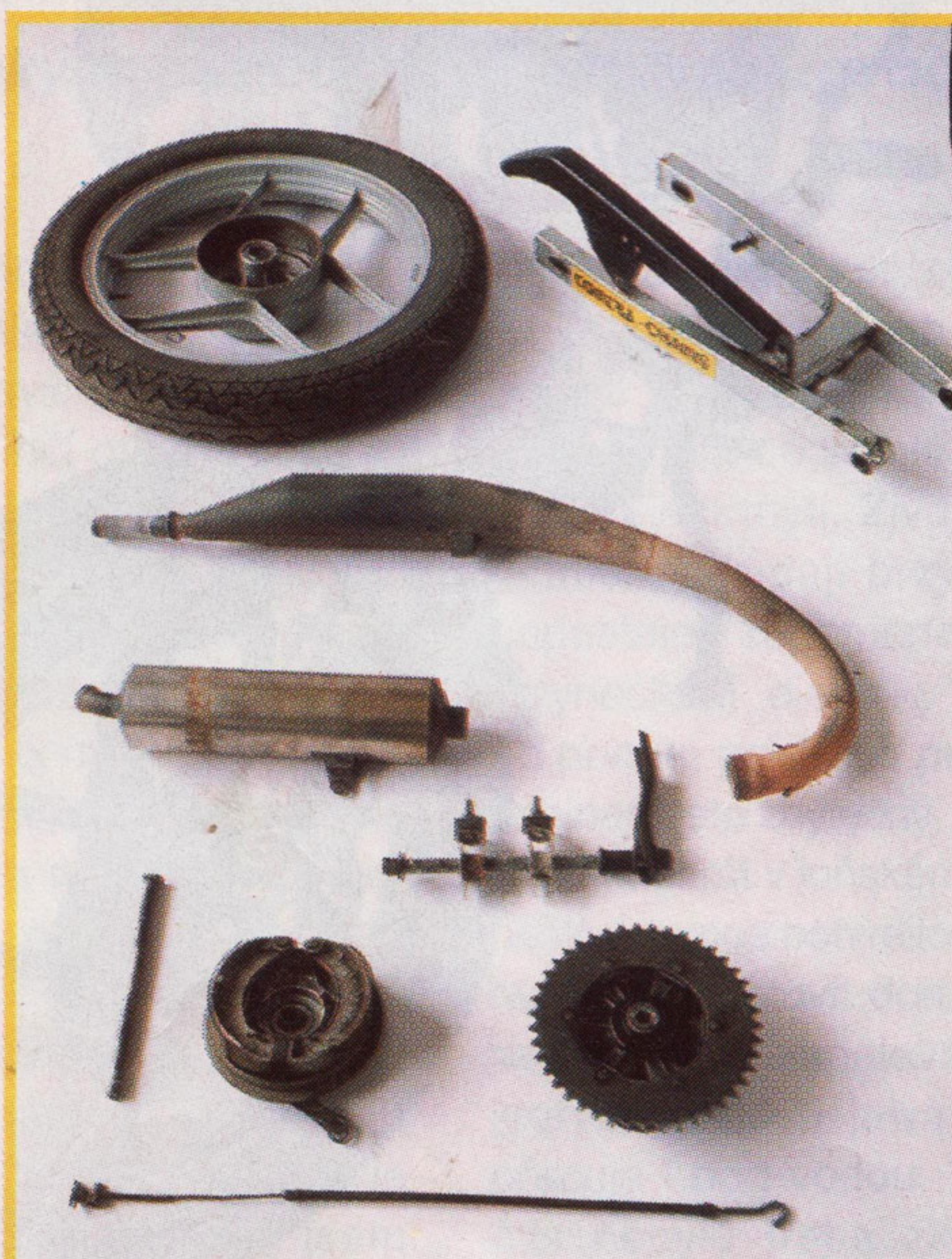
Sníh, sůl a mořské ovzduší se podepsalo na výfukovém potrubí.
